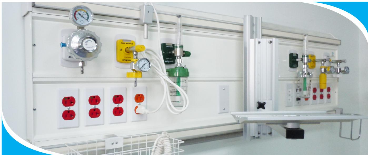
Consola para encamados tipo horizontal fabricada en aluminio de extrusión especial 6063 temple 5, anodizado natural a 10 micras de oxidación con espesor mínimo del perfil de 2,5 y 3 milímetros, con secciones para montaje de rieles de aluminio de deslizamiento horizontal en parte superior e inferior.
