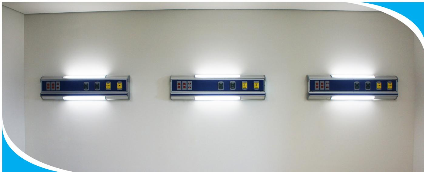
Consola para encamados tipo horizontal fabricada en aluminio de extrusión especial 6063 temple 5, anodizado natural a 10 micras de oxidación con espesor mínimo del perfil de 2.5 y 3 milímetros, con secciones para montaje de rieles de aluminio de deslizamiento horizontal en parte superior e inferior.
