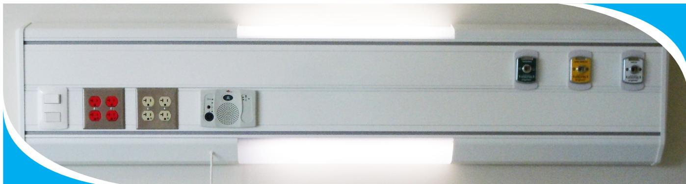
Consola para encamados tipo horizontal fabricada en aluminio de extrusión especial 6063 temple 5, norma de fabricación ASTM B-221-02/AA anodizado natural a 10 micras de oxidación o pintura electrostática horneada en polvo, con espesor mínimo del perfil de 2,5 a 3 milímetros.
