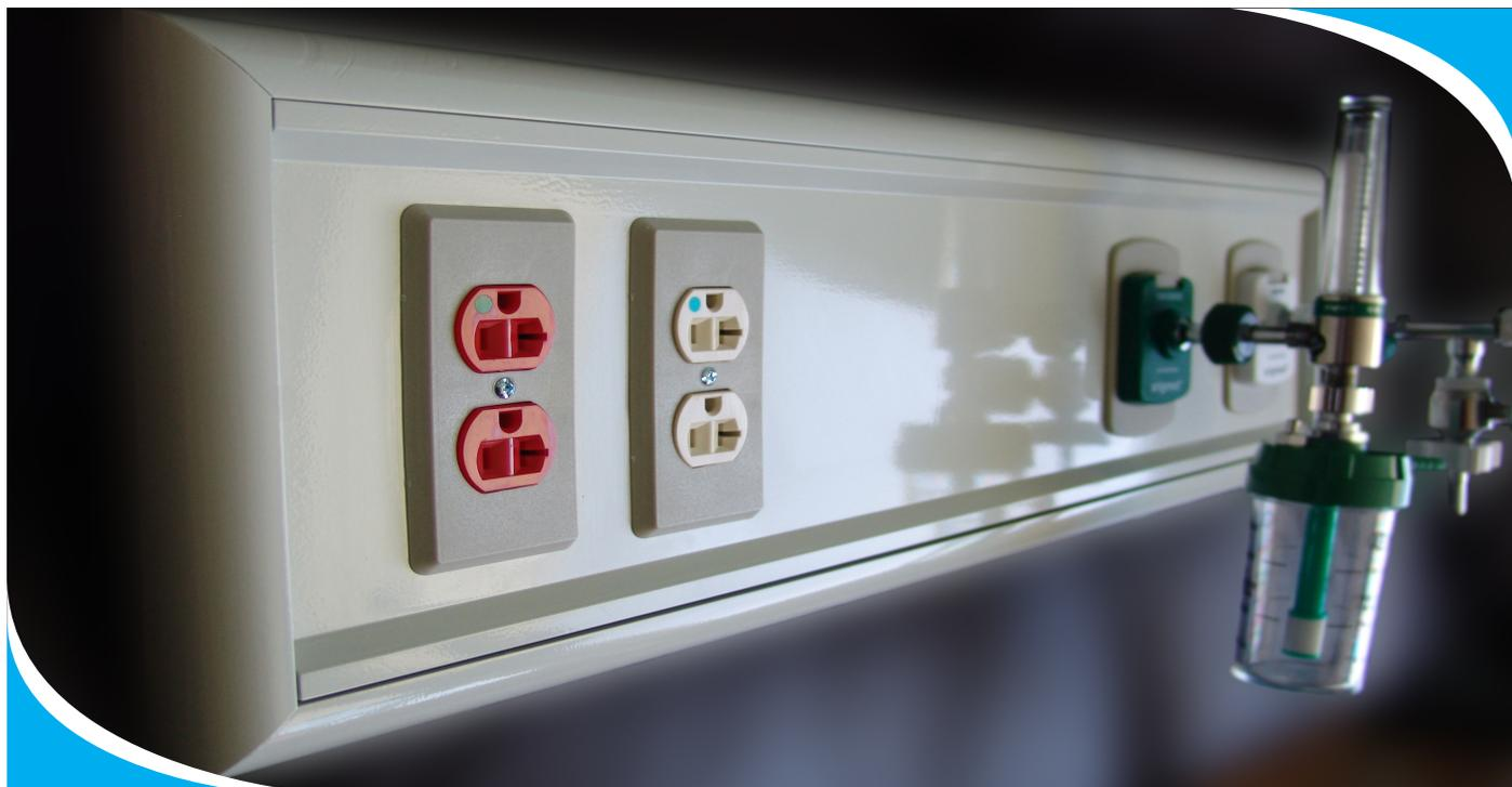
Sistema de consola sencilla de empotrar a muro para servicios básicos, fabricada en aluminio de extrusión especial 6063 temple 5, anodizado natural a 10 micras de oxidación con espesor mínimo del perfil de 3 milímetros, con marco reborde del mismo material, configuración según necesidades.
