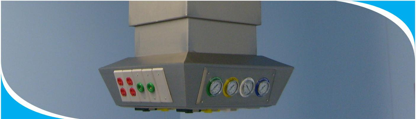
Columna de servicios telescópica para salas de cirugía con motor eléctrico de 8kn de fuerza y alimentación eléctrica a 220v, cuerpos fabricados en lámina de acero inoxidable 304-P3 calibre 18, pulido 3 y con tratamiento para la formación de la capa pasiva; canalizaciones y separaciones internas para la conducción de sistemas de gases médicos, sistemas eléctricos, voz y datos requeridos en el área de salas de cirugía.
