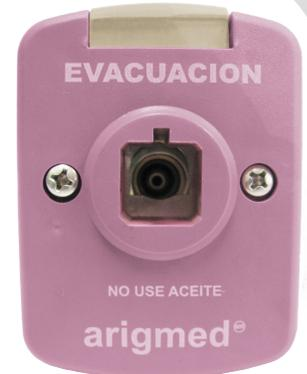
Toma para distribución de gases medicinales de varios tipos de conexión, con doble válvula check de retención, especificado para los servicios indicados y aceptados sólo en correspondencia con la geometría o rosca del adaptador macho de enchufe designado para cada gas.
